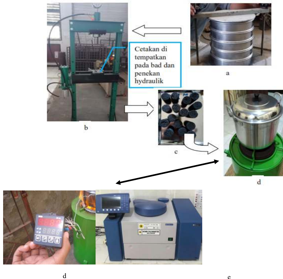
Gambar 1.a. Proses Penyaringan Briket dengan saringan mesh 20, 60 dan 100 , b. Proses mencetak briket arang di mesin cetak hidrolik, c. Hasil cetakan briket setelah selesai di oven, d. Pengujian Boiling Time dan Lama Nyala.e. Pengujian Nilai Kalor dengan alat Tipe C5003
